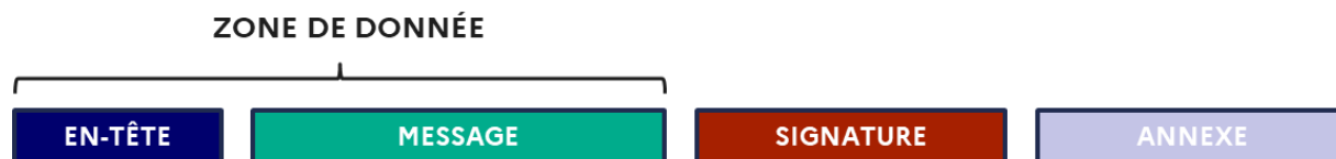
Figure 2: Format global d'un code 2D-DOC
